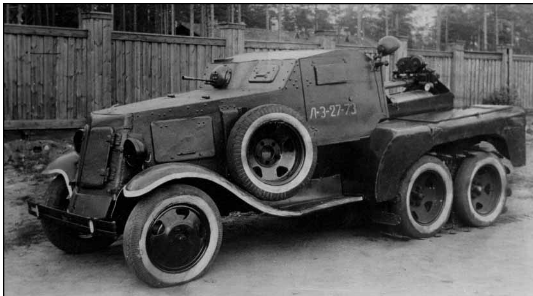
Техника 1-го Воздухоплавательного дивизиона артиллерийского наблюдения. Бронированный автомобиль с лебёдкой для подъёма аэростатов.
